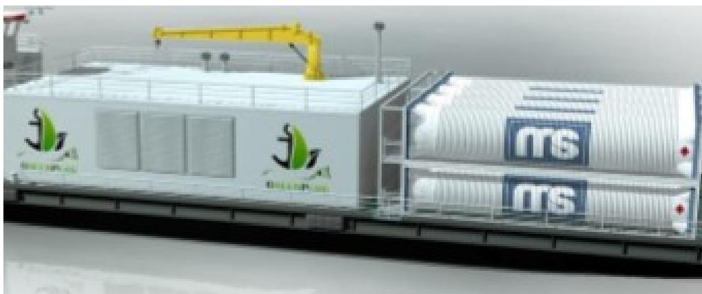
Abb. 2: Tankcontainer und Anlagencontainer der Firma Marine Service, Quelle: Marine Service GmbH
